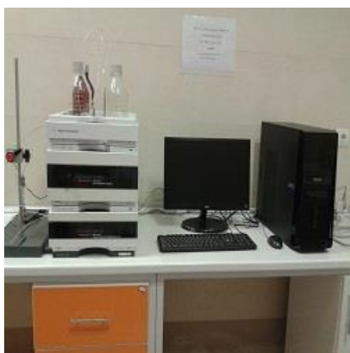
دستگاه: کروماتوگرافی مایع با کارایی بالا (High- performance liquid chromatography (HPLC) مدل: ۱۲۶۰ Infinity شرکت سازنده Agilent: آمریکا
